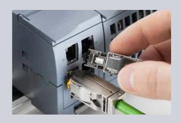
集成以太网接口具有抗干扰和交叉自适应能力 通过紧凑型交换机 CSM1277 可使系统组成线型,树型和星型网络拓扑;
